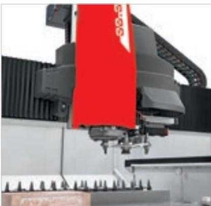
Rotierendes Magazin mit 8 Positionen am Bearbeitungskopf, damit die Wechselzeiten der am häufigsten verwendeten Werkzeuge gesenkt werden.
