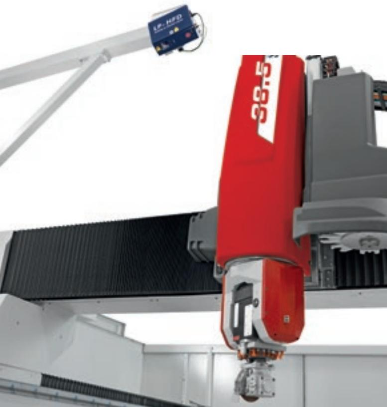
Der Laserprojektor gibt die Position aller Saugnäpfe und zu bearbeitenden Werkstücke auf dem Arbeitstisch wider, vermeidet das Bewegen des Kopfes und sorgt für eine einfache und schnelle Vorbereitung des Arbeitsbereichs.
