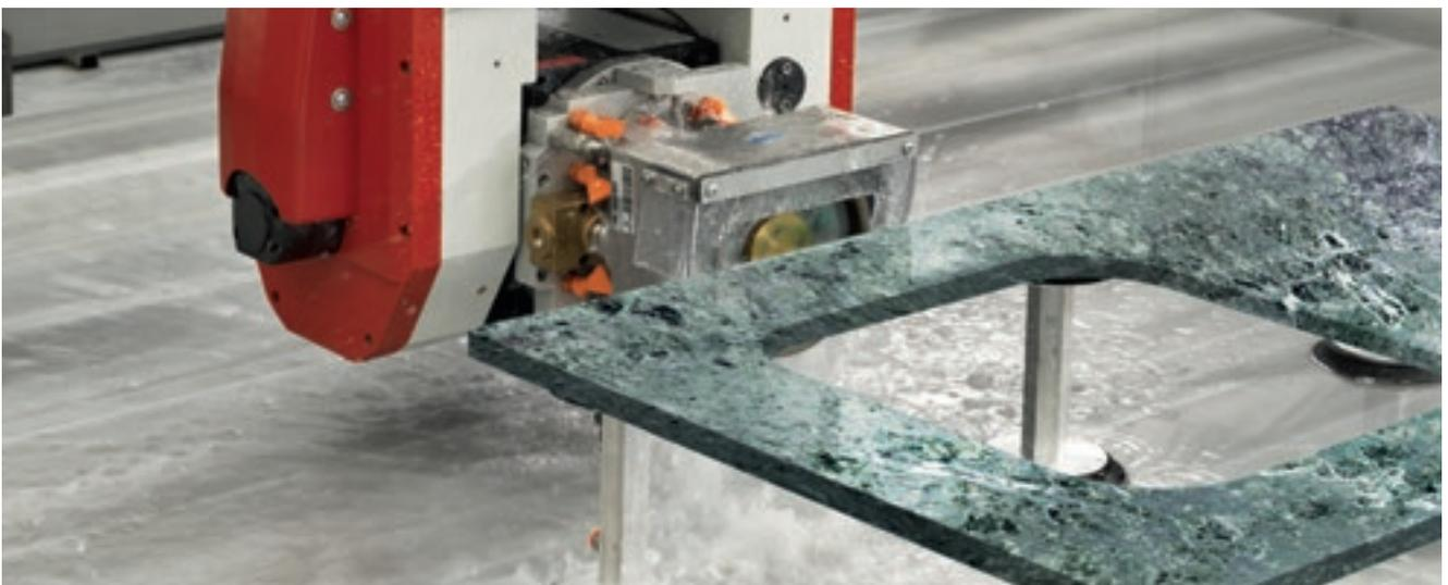
Schleifen der Außenkante mit Topfschleifscheibe.
