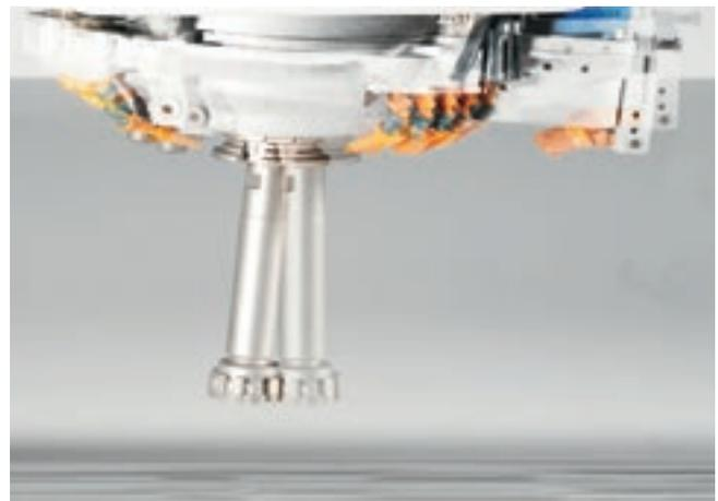
Schwingbare T-Achse ( $\pm 2,5^\circ$ ) zum Ausführen von Aussparungen mit schrägem Arbeitstisch für Küchenarbeitsplatten.
