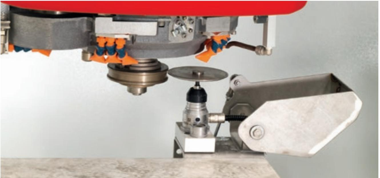
Das mechanische Voreinstellgerät prüft mit einer vom Maschinenbediener einstellbaren Häufigkeit den Verschleißgrad der Diamant-Werkzeuge und aktualisiert die Werkzeugparameter in der Maschinensteuerung automatisch. Dies garantiert eine langfristig gleichbleibende Bearbeitungsqualität und die Vermeidung möglicher Fehler durch den Bediener.
