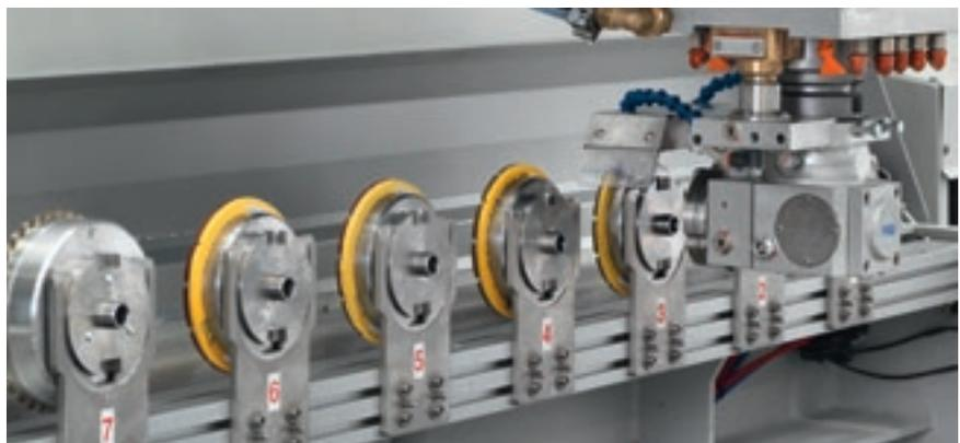
Werkzeugwechselmagazin für Aggregat mit magnetischem Werkzeugwechsel.
