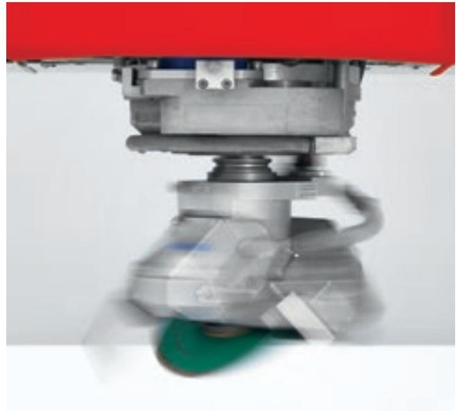
Unendlich rotierende Achse C für die flüssige und präzise, einfach perfekte Ausführung kompliziertester Bearbeitungen.
